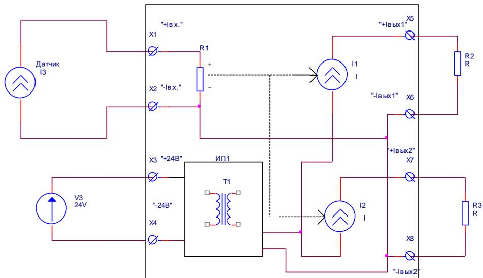
Рис. 1/Схема подключения токового разветвителя преобразователя сигнала ТРПС 1-2-2М
