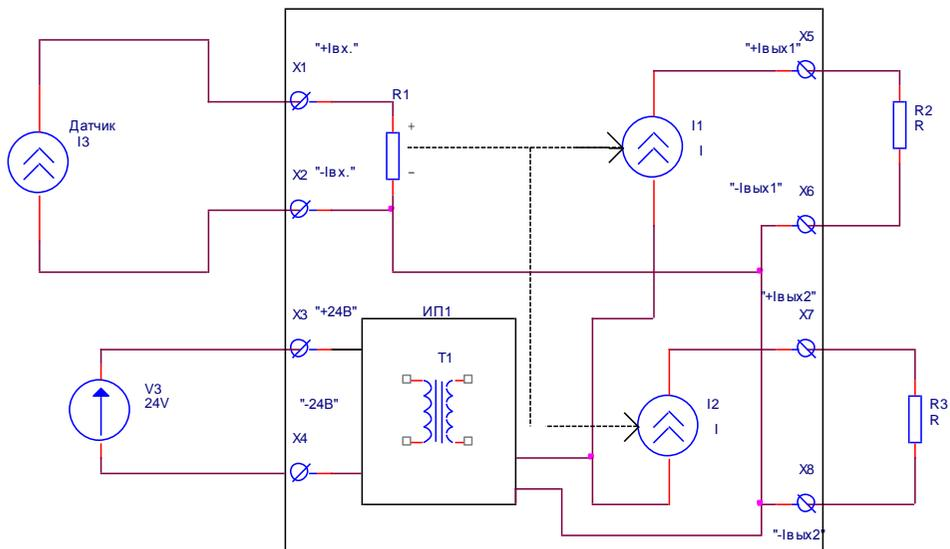
Рис. 1/Схема подключения разветвителя токового сигнала WYE 4-20.
